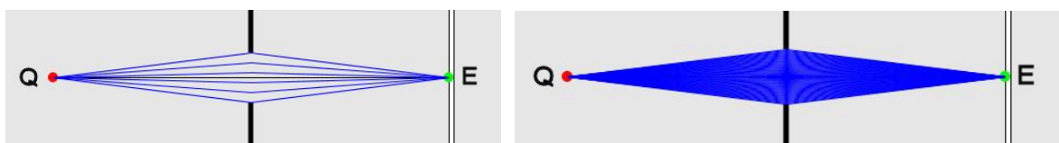
Abbildung 7.3: Links sind sechs Wege für ein Quantenobjekt durch einen Einzelspalt eingezeichnete, rechts 51 Wege
